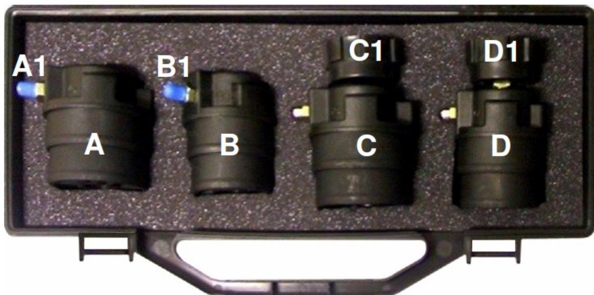
Adattatore per la pressione 2 step ( **A** ) per tubo con  $\varnothing$  65-70 mm valvola Schrader ( **A1** )
